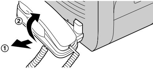
2. Выньте выступ (3), затем отсоедините разъем телефонной трубки (4).
