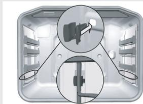
При установке полностью выдвигающихся телескопических направляющих с вкладышами EasyClean установите фиксатора (прилагаются в комплекте) в отверстия в нижней части боковых стенок духовки. Защелкните направляющие в фиксаторах. Фиксаторы обеспечивают более прочную установку направляющих.
