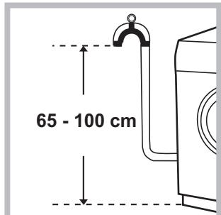
Schließen Sie den Ablaufschlauch, ohne ihn dabei zu knicken, an eine Ablaufleitung, oder an einen in der Wand, in einer Höhe von 65cm bis 100cm an;
