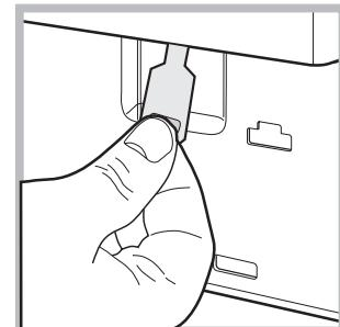
3. Nehmen Sie die Abdeckung (befindlich an der Gerätetür) mit Hilfe eines Schraubenziehers ab (siehe Abbildung).
