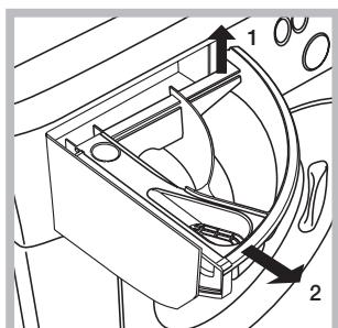
Heben Sie die Schublade leicht an und ziehen Sie sie nach vorne hin heraus (siehe Abbildung). Spülen Sie sie regelmäßig unter fließendem Wasser gründlich aus.
