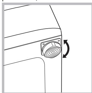
2. Se o pavimento não for perfeitamente horizontal, para compensar qualquer irregularidade, desataraxe ou atarraxe os pés dianteiros (veja a figura); ; o ângulo de inclinação, medido no plano de trabalho, não deve ultrapassar 2°.
