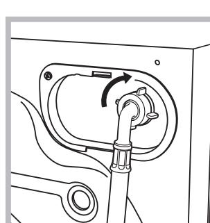
2. A vízbevezető cső csatlakoztatásához csavarozza a csövet a mosogép hátoldalán jobbra fent található vízbemeneti csonakra (lásd ábra).
