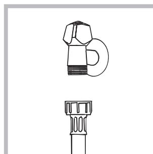
1. Sluit de toevoerbuis aan op de koudwaterkraan met een mondstuk met schroefdraad van 3/4 gas (zie afbeelding). Voordat u de wasdroogmachine aansluit moet u het water laten lopen totdat het helder is.
