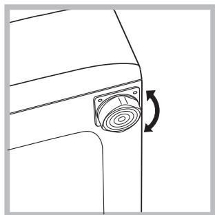
2. Als de vloer niet volledig horizontaal is kunt u de onregelmatigheid opheffen door de stelvoetjes aan de voorkant losser vaster te schroeven (zie afbeelding); de inclinatiehoek, gemeten ten opzichte van het werkvlak, mag de 2° niet overschrijden.
