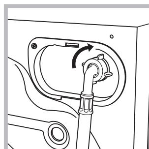
2. Das andere Ende des Schlauches an den oben rechts am Rückteil des Waschtrockneren befindlichen Wasseranschluss anschließen (siehe Abbildung).
