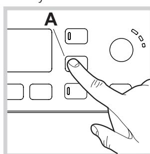
Om het programma te activeren drukt u 5 sec. op de toets **A** (zie afb.). Het programma start automatisch en heeft een duur van circa 70 minuten. Om de cyclus te beëindigen drukt u op de toets START/PAUSE.
