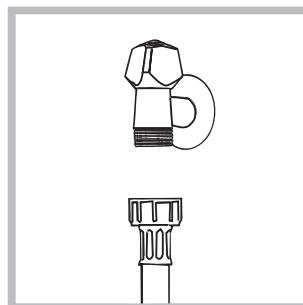
1. A vízbevezető cső csatlakoztatásához csavarozza fel a csövet egy 3/4"-os külső menettel rendelkező hidegvízcsapra (lásd ábra). A csatlakoztatás előtt eressze meg a csapot, és folyassza a vizet addig, amíg az teljesen átlátszóvá nem válik!
