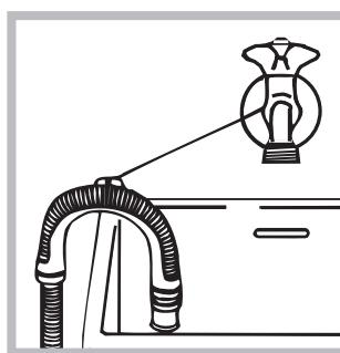
Повесьте загнутый конец сливного шланга на край раковины, ванны, или поместите в специальный вывод канализации. Шланг не должен перегибаться. Верхняя точка сливного шланга должна находиться на высоте 65-100 см от пола. Расположение сливного шланга должно обеспечивать разрыв струи при сливе (конец шланга не должен быть опущен в воду). В случае крепления на край ванной или раковины, шланг вешается с помощью направляющей (входит в комплект поставки), которая крепится к крану (рис.).
