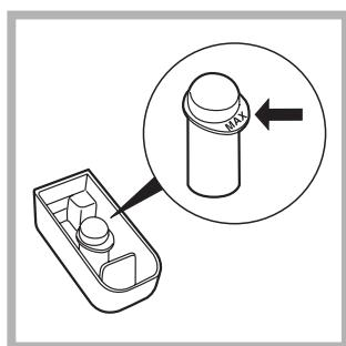
Лоток 4 для отбеливателя вставляется в отделение 1 распределителя моющих средств. Не заполняйте лоток 4 выше отметки max (см. рис.). Для осуществления только отбеливания налейте отбеливатель в дополнительную
