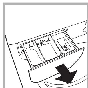
Выньте распределитель, нажав на него с двух сторон и потянув наружу (см. схему»).
