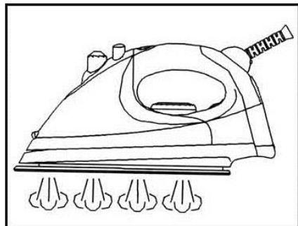
Горящая лампа индикатора нагрева (8) указывает на то, что утюг нагревается. Когда индикатор нагрева погаснет, утюг достиг желаемой температуры. Функция «отпаривание» может осуществляться только при максимальных температурах нагрева. В противном случае возможен выброс горячей воды.
