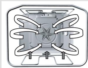
Для консервирования используйте режим
