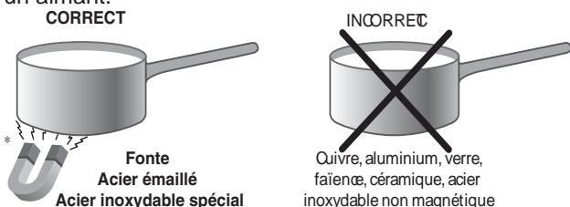
! L'utilisation des adaptateurs, des diffuseurs ou des plaques métalliques sur les zones de cuisson est déconseillée. Cela pourrait se révéler préjudiciable pour la performance de la plaque de cuisson et en endommager l'esthétique.
