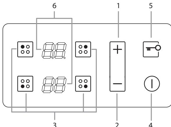
Le bandeau de commande décrit dans le présent manuel n'est qu'un exemple représentatif : il peut ne pas correspondre exactement au bandeau de votre appareil.
