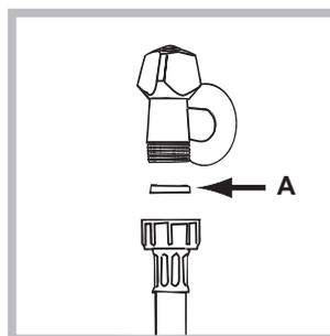
1. Підключити живлячий трубопровід, прикрутивши його до крану холодної води за допомогою штуцера з газовою різьбою 3/4 (див. малюнок). Перед підключенням спустіть воду, доки вона не стане прозорою.
