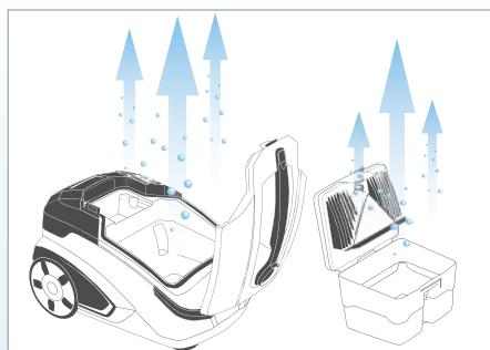
После каждого использования очищать и высушивать аквафильтр, использовавшиеся насадки, а также корпус прибора.
