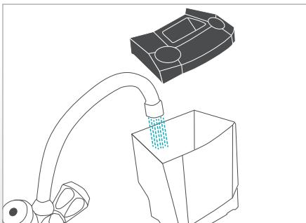
Очистка резервуара для чистой воды (только при влажной уборке)
