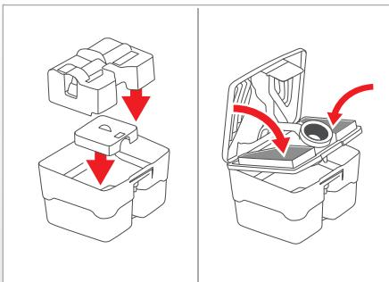
Если был снят всасывающий фильтр, то его необходимо установить в резервуар грязной воды.
