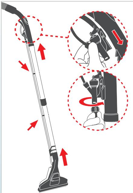
**Присоединить телескопическую трубу с подходящей стороны к рукоятке всасывающего шланга, а насадку для влажной уборки пола - к телескопической трубе.**
