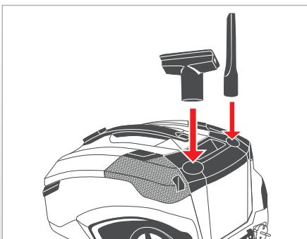
Для того, чтобы всегда иметь принадлежности моющего пылесоса под рукой, можно для хранения вставить насадки в кронштейны, расположенные в крышке резервуара для чистой воды.
