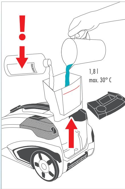
Извлечь резервуар для чистой воды из прибора. Залить в пустой резервуар для чистой воды не более 1,8 литра чистой воды (чуть теплой, не более 30 °C). Установить резервуар для чистой воды на место в прибор. Демонтаж и монтаж резервуара чистой воды описан в гл. «Очистка», раздел «Очистка резервуара для чистой воды».
