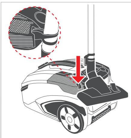
Для кріплення всасуючої трубки на пристрії використовувати парковочне устроїство, розташоване на телескопічній трубі.
