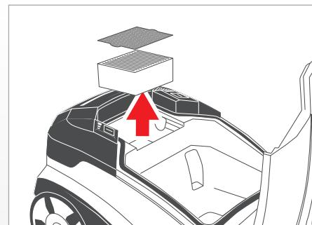
**Özel hijyen filtre ile özel hijyen ön filtresinin temizlenmesi**
