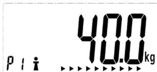
На дисплее будут отображаться номер пользователя и пол. Весы определяют ваш вес, а затем на дисплее появится значок ►, который будет перемещаться, что означает, что весы измеряют процентное содержание воды, костной, мышечной и жировой массы в организме.
