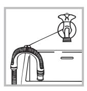
Повесьте загнутый конец сливного шланга на край раковины, ванны, или поместите в специальный вывод канализации. Шланг не должен перегибаться. Верхняя точка сливного шланга должна находиться на высоте 65-100 см от пола. Расположение сливного шланга должно обеспечивать разрыв струи при сливе (конец шланга не должен быть опущен в воду). В случае крепления на край ванной или раковины, шланг вешается с помощью направляющей (входит в комп-
