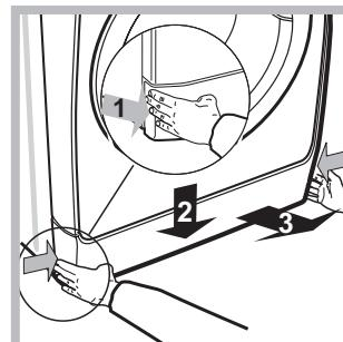
1. зніміть захисну панель з передньої частини машини шляхом натискання у центрі, потім натисніть униз з обох боків та витягніть її (див. малюнки).
