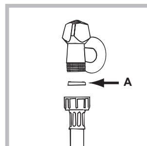
1. Підключіти живлячий трубопровід, прикрутивши його до крану холодної води за допомогою штуцера з газовою різьбою 3/4 (див. малюнок).
