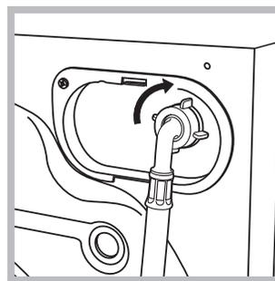
2. Подсоедините заливной шланг к стиральной машине, навинтив его на водоприемник, расположенный в задней части справа (см. рис.).
