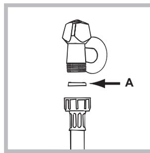
1. Вставьте прокладку A в конец заливного шланга и наверните его на вывод водопровода холодной воды с резьбовым отверстием 3/4 дюйма (см. рис.). Перед подсоединением откройте водопроводный кран и дайте стечь грязной воде.
